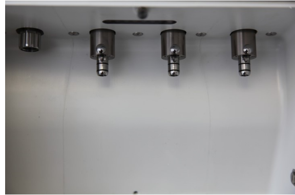
Fig.18 – iCare+ C3: conectores para 3 contra ângulos ou peças de mão
