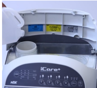
Fig.12 – Enchimento de óleo
