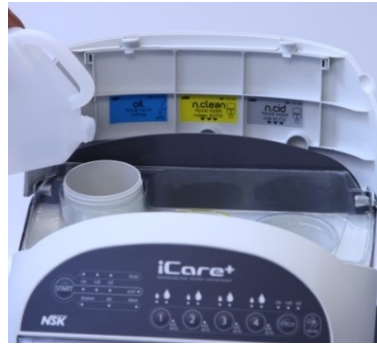
Fig.12 – Enchimento de óleo
